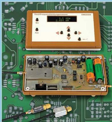
Die Bauelemente des Hochfrequenzleistungsmessers von DM2DSN, s. S. 296 ff., befinden sich im Wesentlichen auf einer Platine. Diese ist demnächst über den FA-Leserservice erhältlich. Um den riesigen Frequenzbereich von 100 kHz bis 3,3 GHz zu überstreichen, benötigt man zwei Tastköpfe. Foto: Red. FA
