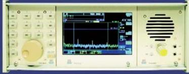
Digitalisierung direkt an der Antenne mit 17 Bit (SFDR >100dB)! Vollständig integrierte Signalverarbeitung, kein PC erforderlich! 2x Audio + Video (Spektrum + Wasserfall) von 0 - 30 / 50 - 54 MHz! Ab Euro 2.750,- (Spektralaufösung 5 Hz, VGA-Display).
