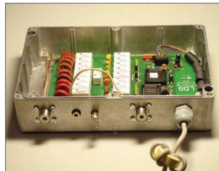
**Bild 7: Das automatische Antennenanpassgerät in einem Aluminiumgehäuse**
