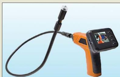
Mit der bereits auf den Titel lancierten **Endoskop-Kamera** für 189 € lassen sich dank Weißlicht-LED und wasserdichtem Kamerakopf unzugängliche Stellen inspizieren und auf 704 x 576 Pixeln darstellen.
