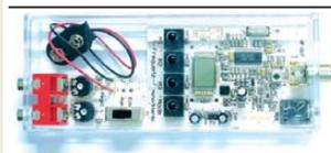
PLL-Prüfgenerator für Abgleich und Reparatur von UKW-FM-Empfängern (UKW-Tuner, Autoradios, tragbare Radios). Frequenzbereich 87,5 bis 108 MHz. Bausatz mit Gehäuse BE-007 31,50
