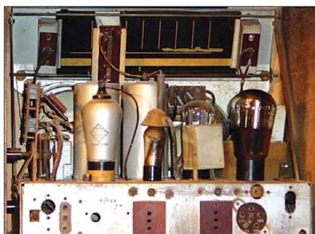
**Bild 7: Innenansicht eines Lorenz *Reflex KW* von 1934**
