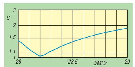
**Bild 16: Simulierter SWV-Verlauf der 10-m-Moxon-Antenne, Entwurfsfrequenz 28,2 MHz**
