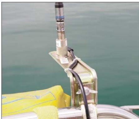
**Bild 6: Nahaufnahme der Befestigung für die UKW-Antenne**
