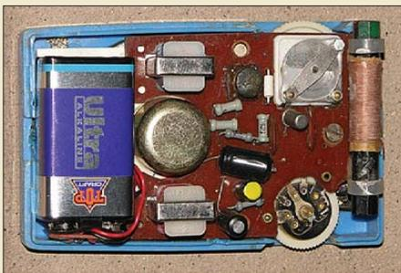
Schon zu Beginn der Ära der Röhrenempfänger und weiter bei Einführung der Transistortechnik wurden Schaltungstricks angewendet, die die Zahl der teuren Verstärkerbauelemente reduzierten und dadurch Kosten senkten, wie hier beim „miniaturisierten“ Innenleben des Zweitransistor-Reflexempfängers Queen von 1960.
