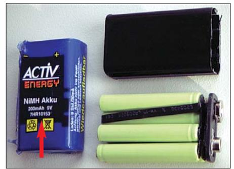
**Bild 4:** 9-V-Akkumulator mit irreführender IEC-Bezeichnung; die richtige Bezeichnung wäre entsprechend Aufbau **7HR 7/42**.
