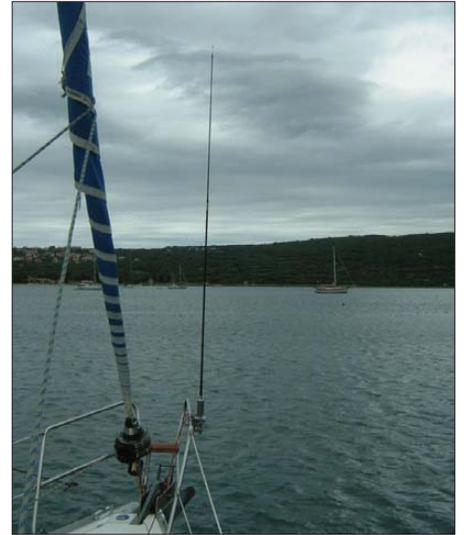
**Bild 4:** Ein Kurzwellenmobilstrahler am Bug des Bootes
