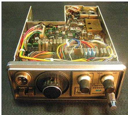
**Bild 2: Blick auf die Unterseite des geöffneten TR-2200GX im Originalzustand, im Vordergrund die beiden Reihen Sende- und Empfangsquarze**
