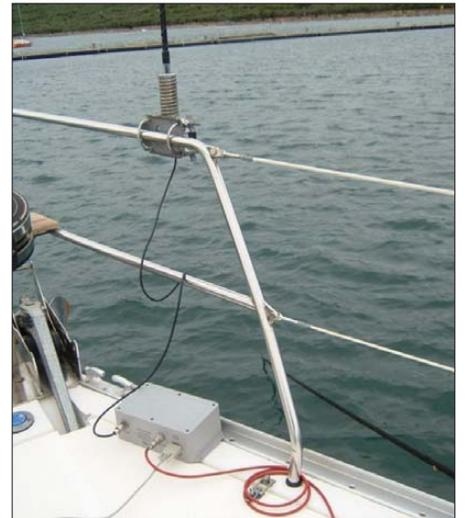
**Bild 5:** Das automatische Antennenanpassgerät RT-11 beim Einsatz an Bord
