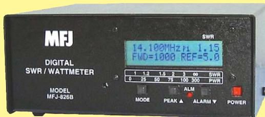
Der eingebaute Frequenzzähler misst sehr genau (+/- 1%). Ebenso präzise wird die Leistung angezeigt: Die Auflösung beträgt im Bereich bis 100 Watt 0.1 bzw 1 Watt im Bereich über 100 W. Leistung und SWR können sowohl numerisch als auch an einer zweizeiligen Balken-Anzeige abgelesen werden.
