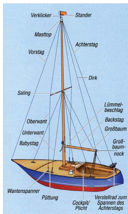
Bild 2: Bootsaufbau im Detail
