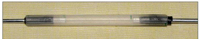
Da der Reflektor eine Gesamtlänge von >1 m hat, sind zwei der Schweißdrähte zu verbinden. Auch dazu kommt analog eine Lüsterklemme mit einer Drahtbrücke zum Einsatz. Das Mittelstück verändert nicht die Gesamtlänge, wie sie im Abschnitt A von Bild 1 angegeben ist. Zur größeren Steifigkeit des Systems werden die Enden mit einem Plastikröhrchen miteinander verbunden, wie Bild 9 zeigt.
